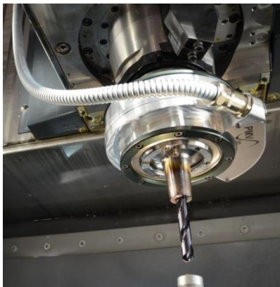
Bild 1: Ultraschall-Schwingsystem für Bohr- und Fräswerkzeuge (Quelle: Fraunhofer IWU)
