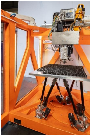
Bild 3: SEAM – der weltweit schnellste Industrie-3D-Drucker für Hochleistungskunststoffe (Quelle: Dirk Hanus / Fraunhofer IWU)
