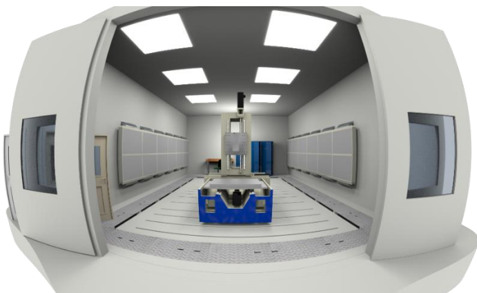
Bild 2: Klimazelle zur exakten Ermittlung thermischer Effekte bei Werkzeugmaschinen (Quelle: Andy Creutziger / Fraunhofer IWU)
