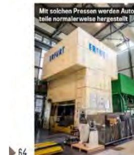
Versuchspresse zum Umformen von Bipolarplatten für Brennstoffzellen
