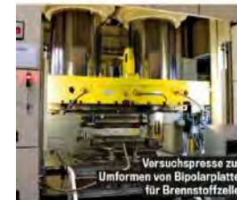
Mit solchen Pressen werden Autoteile normalerweise hergestellt
