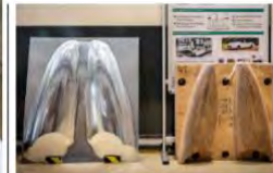
Links die fertigen Kotflügel, rechts die Holzform, über die das Blech zuvor gelegt und dann mit dem Dorn bearbeitet wurde
