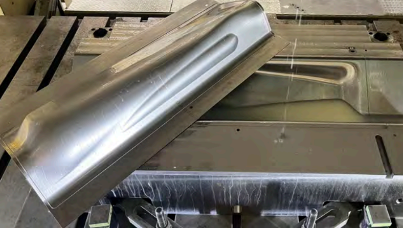
Hochdruckblechumformung eines Bauteiles für eine Dampfturbinenschaufel
