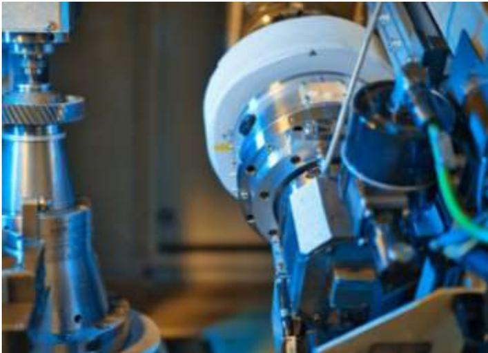
**Abb. 2 Datenlieferant im ECC4P – die Prozesskontrolle im intelligenten und adaptiven Wälzschleifen: Durch eine 100 Prozent Prozessüberwachung mit Anomaliedetektion wird eine konstant hohe Qualität sichergestellt. Die adaptive Regelung des Axialvorschubs steigert die Produktivität, während die Regelung des Shiftwegs die Standzeit der Schleifschnecke verlängert.**
