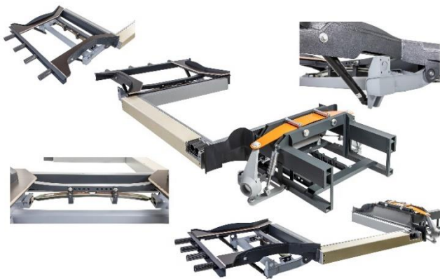
Abb. 1 Mit einem kreislaufgerechten Open-Source-Baukasten können die einzelnen Komponenten über mehrere Fahrzeuglebenszyklen hinweg verwendet werden.
