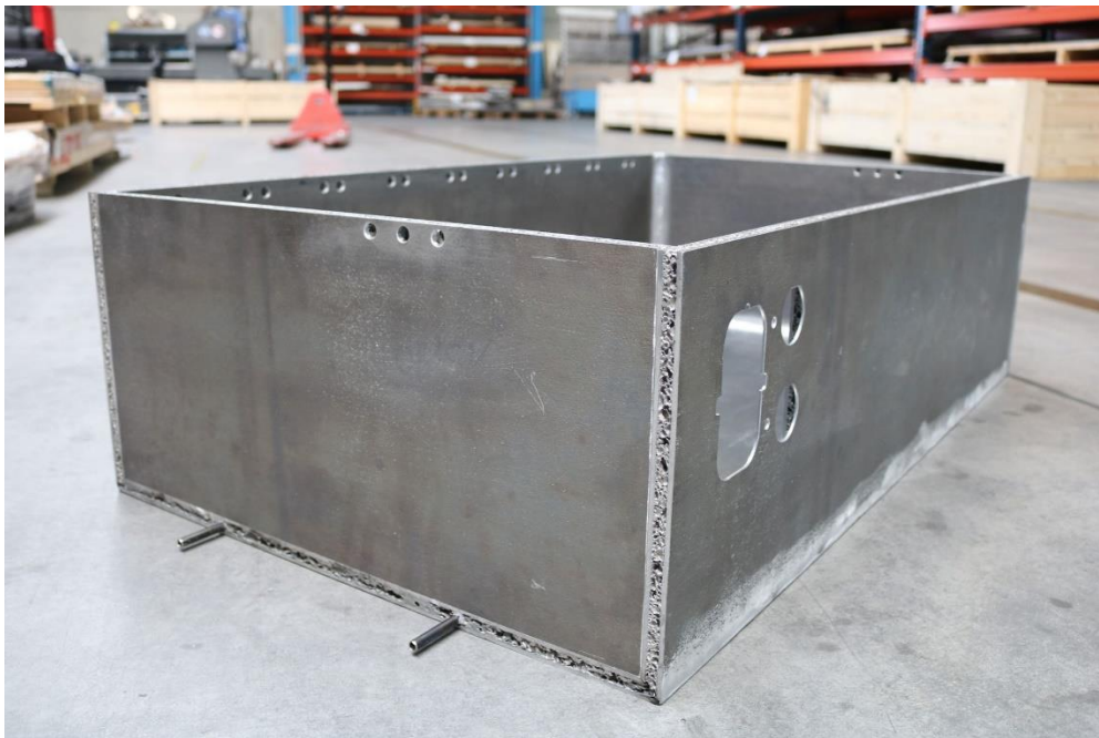
Bild 1: Batteriesystem mit integriertem Kühlsystem (Seitenansicht). Fotoquelle: Havel metal foam
