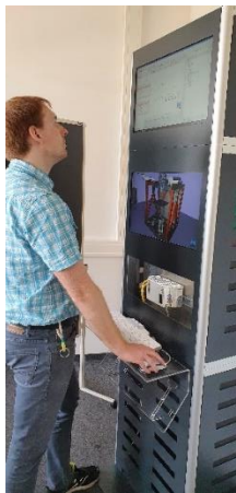
Bild1: Wissenschaftler bei der virtuellen Inbetriebnahme einer Produktionsanlage am Simulationsturm (Quelle: Fraunhofer IWU)
