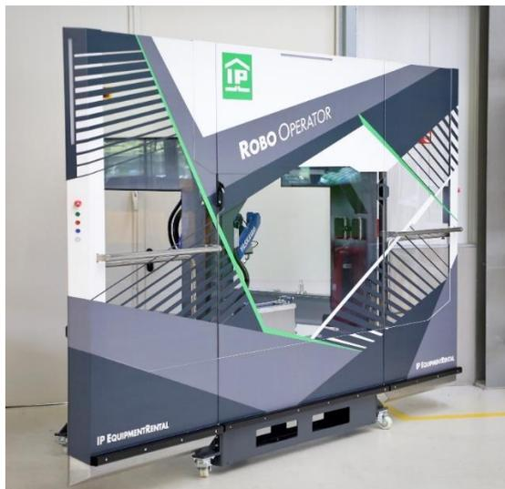
Bild 1: »Robo Operator« zur autonomen Steuerung von Werkzeugmaschinen (Quelle: IP)
