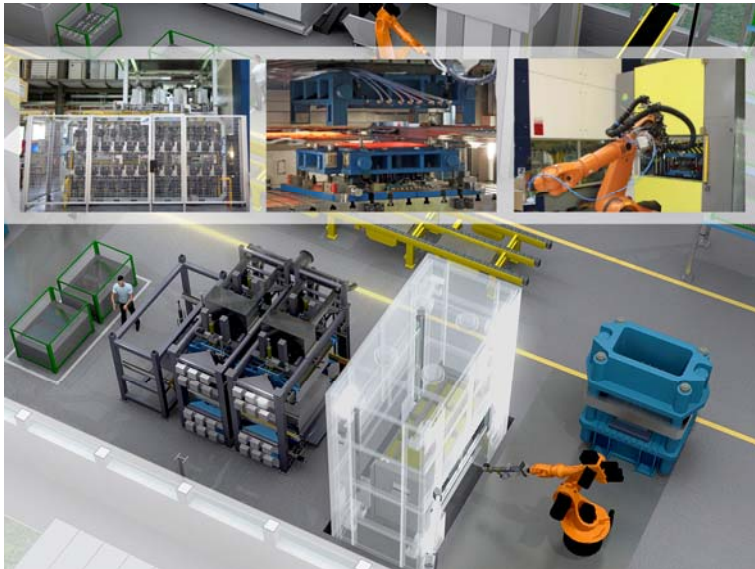
BU: Presshärtelinie: Kontakterwärmungsanlage, Presse, Handlingsystem und Beschnitt (v.l.n.r).
