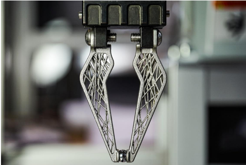
Bild 2: Beispiel für additiv gefertigte Industrie-Greifer im Einsatz © Fraunhofer IWU
