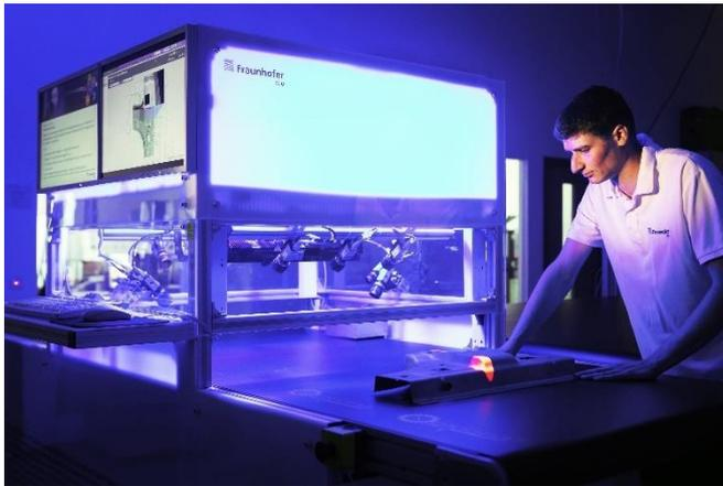
**Abb. 5 XEIDANA® übernimmt die Endkontrolle im Rahmen einer 100%-Prüfung und kommt als KI-basiertes, adaptives Werkzeug auch nicht bekannten Fehlern auf die Spur.**
