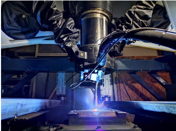
(3) 3D-Druck mit Laserauftragschweißen © Metrom GmbH
