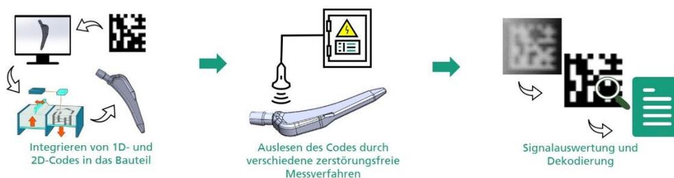
Bild 1: Schematische Darstellung der Prozesskette der Bauteilidentifizierung (Quelle: Fraunhofer IWU)
