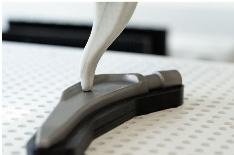
Bild 2: Bei einem Hüftschaff-Implantat aus Titan (Demonstrations-Modell) wird der integrierte Code kontaktlos per Wirbelstrom ausgelesen (Quelle: Fraunhofer IWU)
