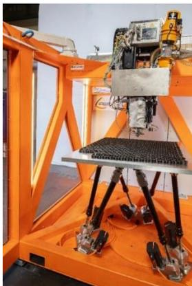
Bild 1: SEAM – der weltweit schnellste Industrie-3D-Drucker für Hochleistungskunststoffe (Quelle: Dirk Hanus / Fraunhofer IWU)
