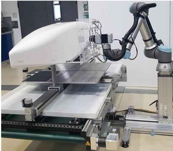
**Abb. 1 Dig-Circle: Automatische zerstörungsfreie Prüfung eines Fairings (Verkleidungsteils) mittels aktiver Thermografie, um Bauteilschäden zu erfassen und für die Kreislaufwirtschaft zu verwerten**
