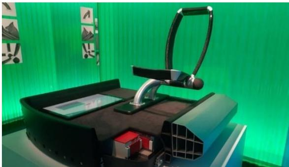
**Abb. 2 FiberEUse: Technologiedemonstrator, der das Konzept der wiederverwertbaren Fahrzeugplattform und Sitzstruktur darstellt**
