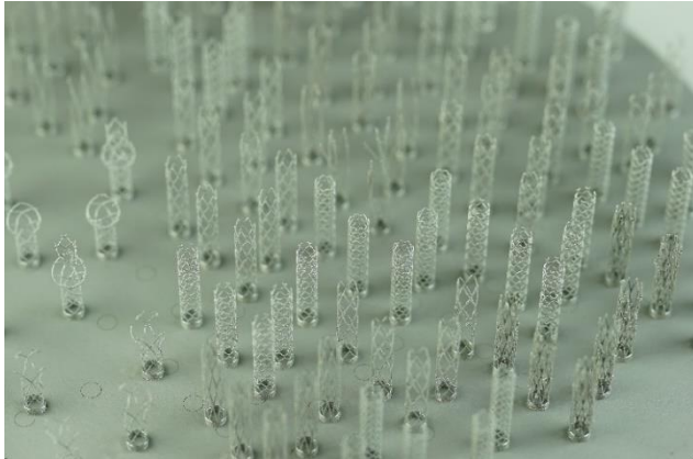
Abb. 2 LPBF ermöglicht die Herstellung individueller Stents in der gleichen Charge (Bauplatte) © Fraunhofer IWU www.iwu.fraunhofer.de
