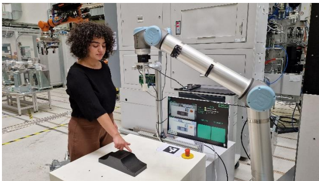
Abb. 3 Dursune Gönültaş und ihr Forschungsthema, die Programmierung einer Roboterbahn durch Gestensteuerung © Fraunhofer IWU www.iwu.fraunhofer.de
