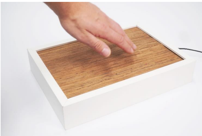
Abb. 4 Furnier mit rückseitig aufgedruckten kapazitiven Sensoren © Fraunhofer IWU
