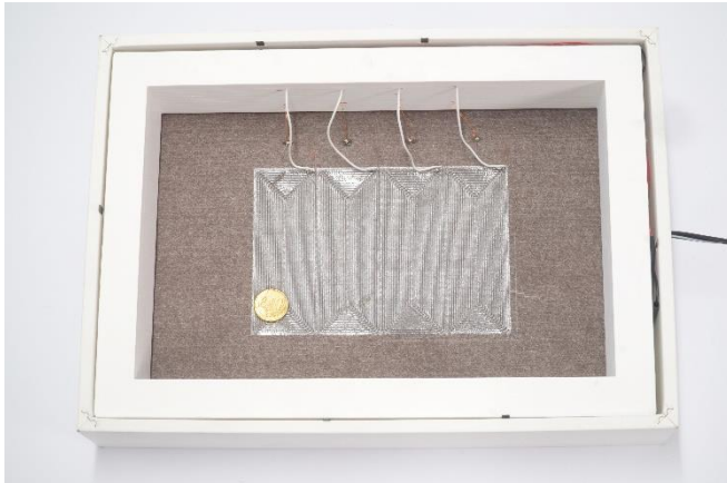
Abb. 5 Auf Furnierrückseite aufgedruckte kapazitive Sensoren © Fraunhofer IWU
