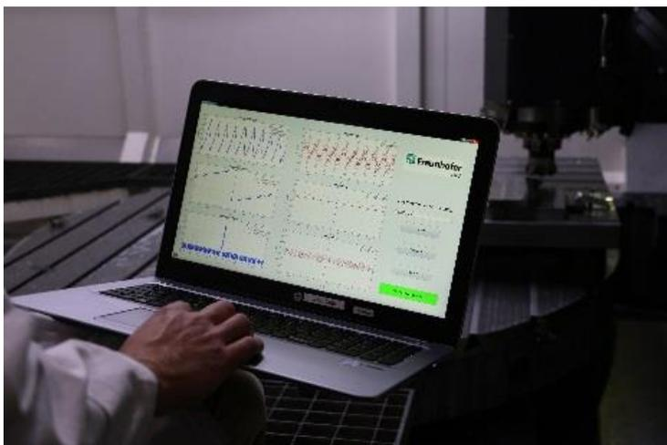
BU: Das Monitoringsystem des Fraunhofer IWU generiert praktisch in Echtzeit genaue Informationen über die reale Werkzeugbahn.
