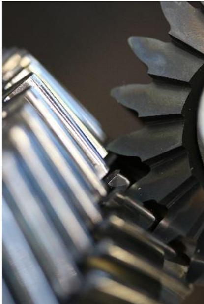
BU: Das Wälzschälen ist ein relativ neues Verfahren für die Fertigung qualitativ hochwertig verzahnter Bauteile, wie sie bspw. in Planetengetrieben für die Elektromobilität benötigt werden.
