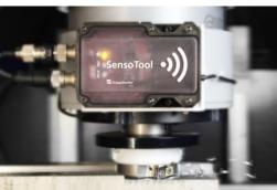
SensoTool ist ein »taktiles« Werkzeug. Es registriert Prozessgrößen dort, wo sie auftreten – direkt an den Wendeschneidplatten des Fräskopfes. | Quelle: © Fraunhofer IWU | Bildquelle in Farbe und Druckqualität <a href="http://www.iwu.fraunhofer.de/de/presse">http://www.iwu.fraunhofer.de/de/presse</a> und medien.html
