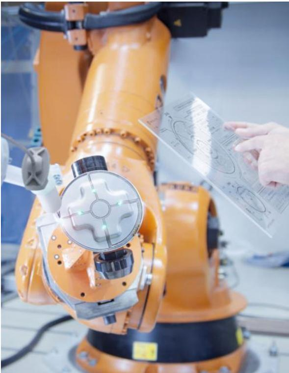
**Bild 1, Demonstrator »Funktionsdruck«:** Das vom Fraunhofer IWU und verschiedenen Projektpartnern entwickelte Verfahren ersetzt u.a. das aufwändige Konfektionieren und Verlegen von Kabelbäumen, beispielsweise in Autotüren. Leiterbahnen und Sensoren werden stattdessen von einem Roboter auf die entsprechenden Komponenten der Tür gedruckt. Dies ermöglicht es, die Bauteile, individuell, schnell und effizient mit elektronischen Funktionen zu versehen.
