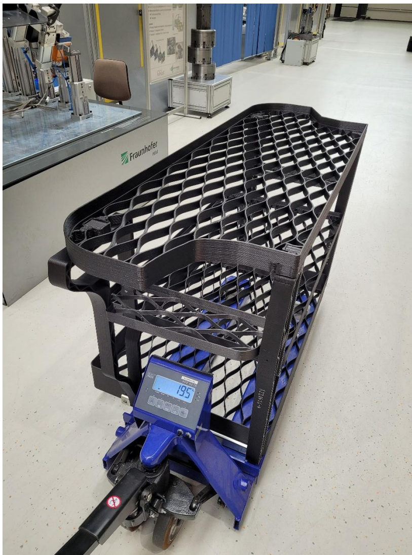
Abb.1 Leichtgewicht: nur 19,5 Kilogramm und damit weniger als halb so viel wie das Standardregal wiegt das 3D-gedruckte Heckregal von Fraunhofer IWU und MOSOLF Special Vehicles GmbH. © Fraunhofer IWU
