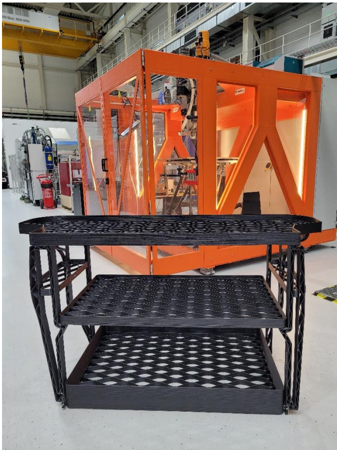
Abb.3 Screw Extrusion Additive Manufacturing (SEAM): Dank der Parallelkinematik kann die Bauplattform in X-, Y- und Z-Achse gekippt und so unter der Düse der Plastifiziereinheit entlang bewegt werden, dass die zuvor programmierte Bauteilform in einem realen 5-Achs-3D-Druckprozess nahezu stützstrukturfrei erzeugt wird. © Fraunhofer IWU
