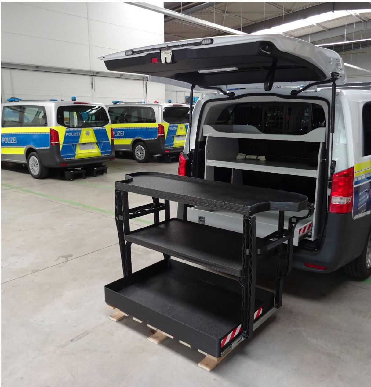
Abb.2 Für die Befestigung können die fahrzeugeitig vorgesehenen Fittings in der Bodenschiene genutzt werden. Der Vergleich mit dem Standardregal (eingebaut) zeigt die optimierte Raumaussnutzung des 3D-gedruckten Modells. © MOSOLF Special Vehicles GmbH
