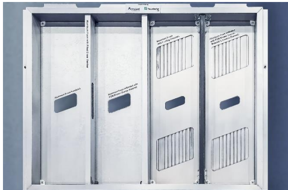
Abb. 1 Möglicher Gehäuseaufbau. In den vier Kammern von links nach rechts: reines AAS, AAS mit infiltriertem PCM, AAS mit Kühlstruktur, AAS mit Kühlstruktur und PCM.
