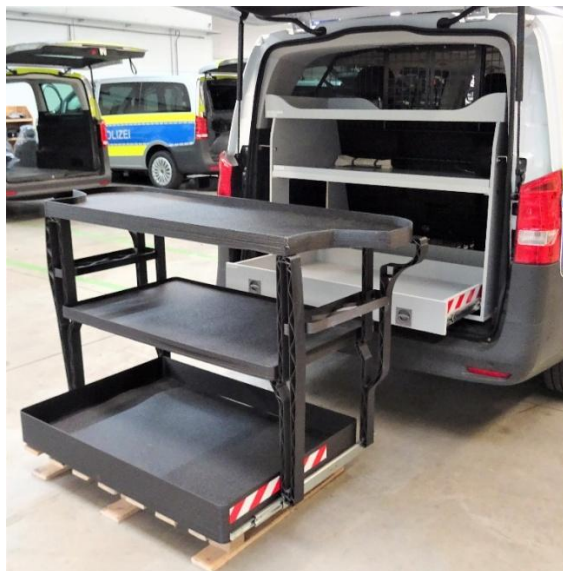
Abb. 2 Das Fraunhofer IWU und die MOSOLF Special Vehicles GmbH haben ein 3D-gedrucktes Heckregal entwickelt, das am Beispiel des Mercedes Vito im Vergleich zur bisherigen Nachrüstlösung einschließlich der Beschläge 26,5 Kilogramm einspart. Dabei bleibt die Nutzlast des Regalsystems vollständig erhalten. Das im SEAM-Verfahren gedruckte Regal schmiegt sich vollständig an die Fahrzeughaut, erfordert keine zusätzlichen Versteifungen oder Befestigungen und nutzt so den Bauraum im Heckbereich bestmöglich aus. © MOSOLF Special Vehicles GmbH
