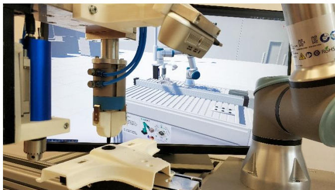
Abb. 2 GreenBotAI-Demonstrator. So einfach und effizient kann Robotik sein: gesteuert durch 2D-Bilder nimmt der Roboter ein Bauteil auf und passt es kraftmomentgesteuert dank intelligenter KI in ein zweites Zahnrad ein. © Fraunhofer IWU (Aufnahme in der Hochschule München)
