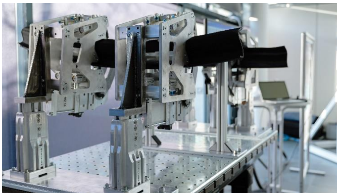
Abb. 3 Am Fraunhofer IWU entwickeltes Spannelement für das automatisierte Spannen und Fügen von thermoplastischen Kohlefaser-Verbundmaterialien bei Flugzeugtüren (z.B. Querträger). © Fraunhofer IWU
