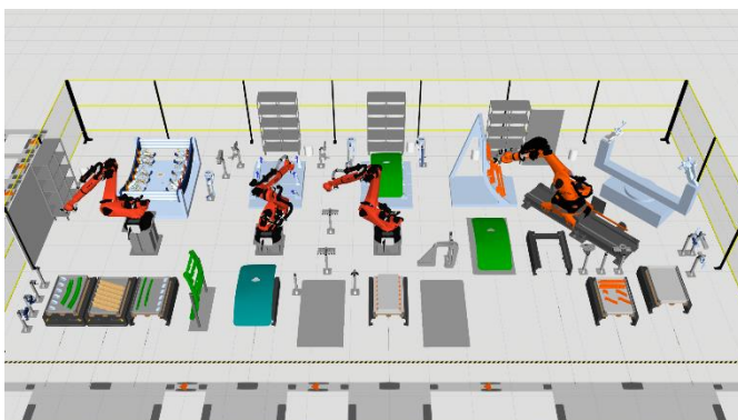
Abb. 1 Screenshot (siehe Video online): durchgehend automatisierte Montage-/ Fügeprozesse bzw. Logistik für die Türstruktur © Fraunhofer IWU
