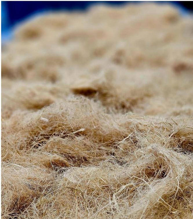
**Abb. 1 Hanffasern statt Glasfasern: Biogene Reststoffe können in SMCs Kunstfasern ersetzen, deren Herstellungsprozess energieintensiv ist. Im Bild: Größere Hanffasern auf dem Förderband vor dem Aufschließen und Verbinden mit der Matrix.**
