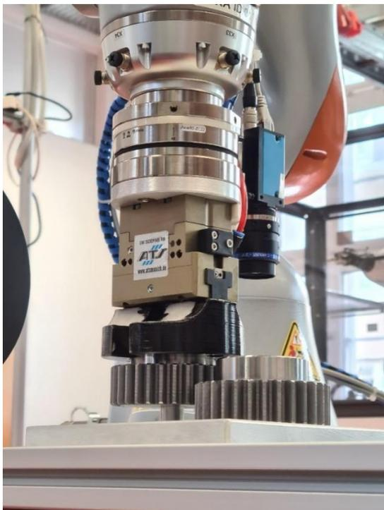
**Abb. 1** So einfach und effizient kann Robotik sein: gesteuert durch 2D-Bilder nimmt der Roboter ein Bauteil auf und passt es kraftmomentgesteuert dank intelligenter KI in ein zweites Zahnrad ein. Aufnahme: Hochschule München, 22. März 2024
