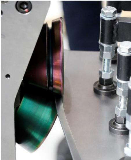
**Abb. 2 Roboter-Rollformen: Ein optisches Messsystem erfasst die erreichte Ist-Geometrie, um so Abweichungen zu erfassen, die sich bei folgenden Zyklen korrigieren lassen**
