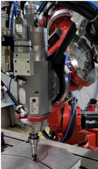
**Abb. 1 Roboter-Schleifen: Eine Ausgleichseinheit hält Anpresskraft und Abtrag beim Schleifen von Freiformflächen konstant**
