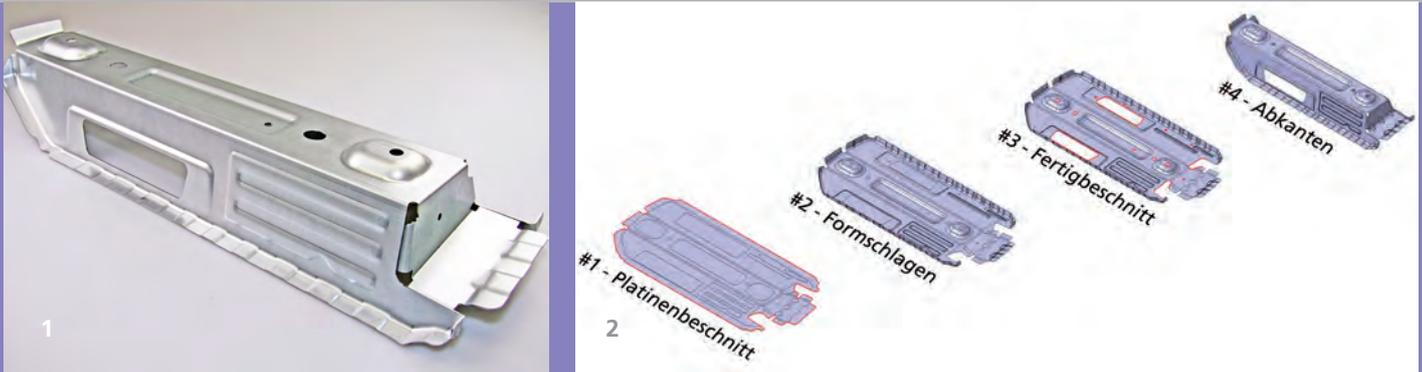
1 Flexibel hergestellter Demonstrator (Werkstoff: DP600, Blechdicke: 1,5 mm)
