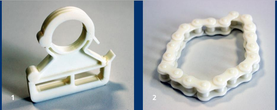
1 Funktionsbauteil mit integrierten Scharnieren
