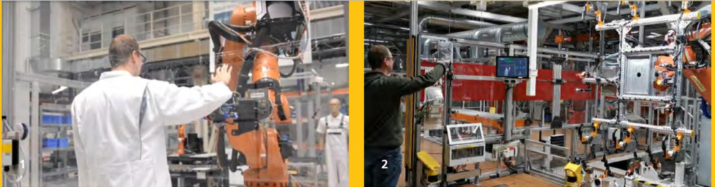
1 *Gestensteuerung eines kollaborierenden Schwerlast-Roboters im Versuchsfeld des Fraunhofer IWU*
