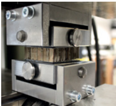
Versuchsaufbau zur Ermittlung mechanischer Kennwerte
