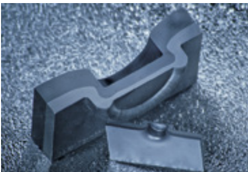
Clinchpunkte im Vergleich: Dickblech ( t_{ges} = 10\text{ mm} ) vs. Feinblech ( t_{ges} = 2,5\text{ mm} )
