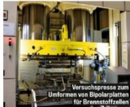
Versuchspresse zum Umformen von Bipolarplatten für Brennstoffzellen
