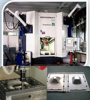
2004: Basisstudien unter Verwendung der Parallelkinematik-Fräsmaschine Mikromat 6X
