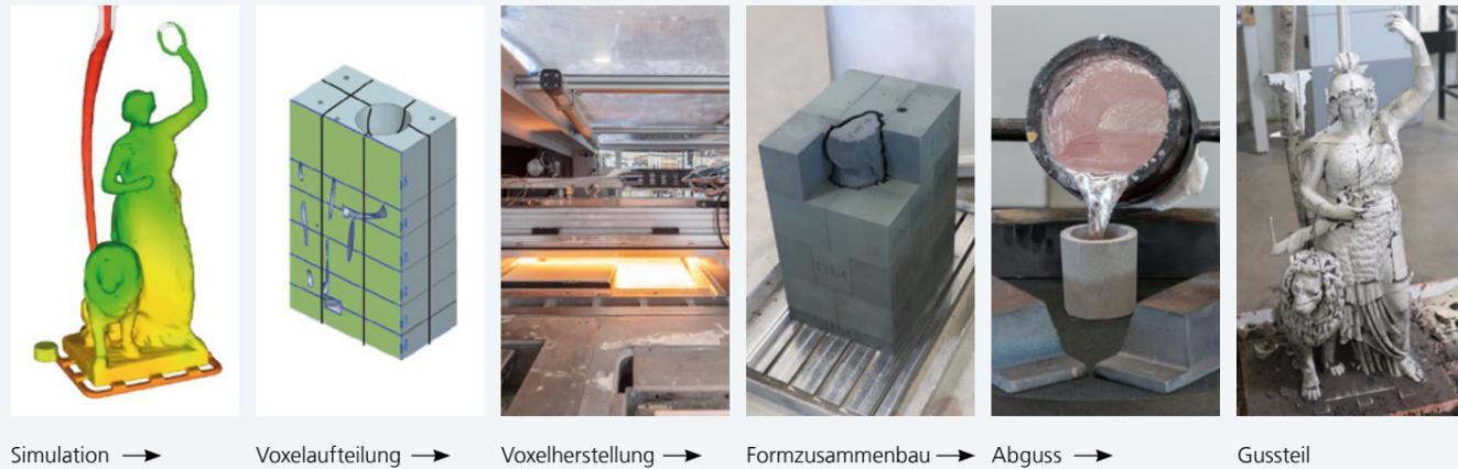
Simulation → Voxelauflösung → Voxelherstellung → Formzusammenbau → Abguss → Gussteil
