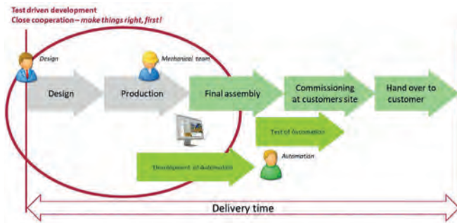
Abbildung 2: Test driven development als Basis der Wandlungsfähigkeit; Quelle: Maier Werkzeugmaschinen GmbH & Co. KG
