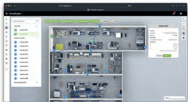
Abbildung 2: Ansicht Coriva-Engine (Backend des ZIGPOS-RTLS) zur Einrichtung und Steuerung; Quelle: ZIGPOS GmbH
