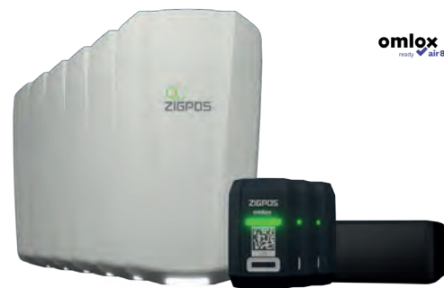
Abbildung 1: ZIGPOS-Hardware-Komponenten: links Satelliten, rechts Tags; Quelle: ZIGPOS GmbH
