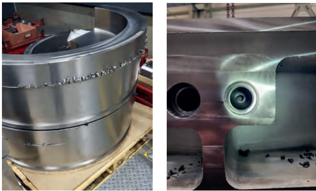
Abbildung 2: Werkstücke mit Grat als Einsatzbeispiele für das roboterbasierte Entgraten; Quelle: HAVLAT Präzisionstechnik GmbH
