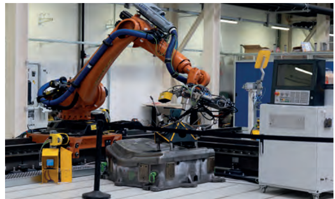
Abbildung 4: zur Nachbearbeitung eines Tiefziehwerkzeugs; Quelle: Fraunhofer IWU
