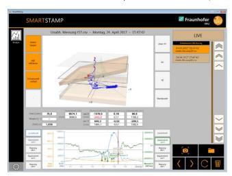
Mittels »Smart Stamp« kann beispielsweise das durch das Werkzeug eingeleitete Kippmoment sichtbar gemacht und der Einfluss auf die Technologie abgeleitet werden.
