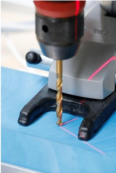
**Abb. 1 Messedemonstrator des Fraunhofer IWU auf der Automatica: Die KI erkennt z. B. auch bei Verbundmaterialien, wann in Holz oder Kunststoff gebohrt wird. Dies kann genutzt werden, um Prozessparameter online KI-gesteuert anzupassen.**
